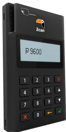
**Модель P17** – продвинутый ридер с технологией NFC. Принимает карты с чипом, магнитной полосой и NFC, а также платежи Apple Pay и Samsung Pay. Операция подтверждается вводом PIN-кода или подписью на экране мобильного устройства. Решение соответствует стандарту безопасности PCI DSS.
